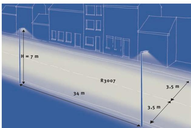
Durante 4.000 horas de funcionamiento anual, para 100 m de carretera, las luminarias Piano Mini equipadas con 56 LED tendrán un consumo eléctrico anual de 1070 kWh, y mantendrán el promedio de iluminancia necesaria de 0,75 cd/m<sup>2</sup>.
